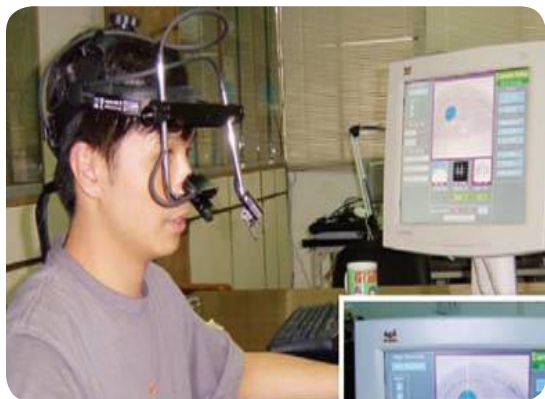
圖四、頭戴式與遙測式眼動儀裝置 (a) 頭戴式眼動儀
